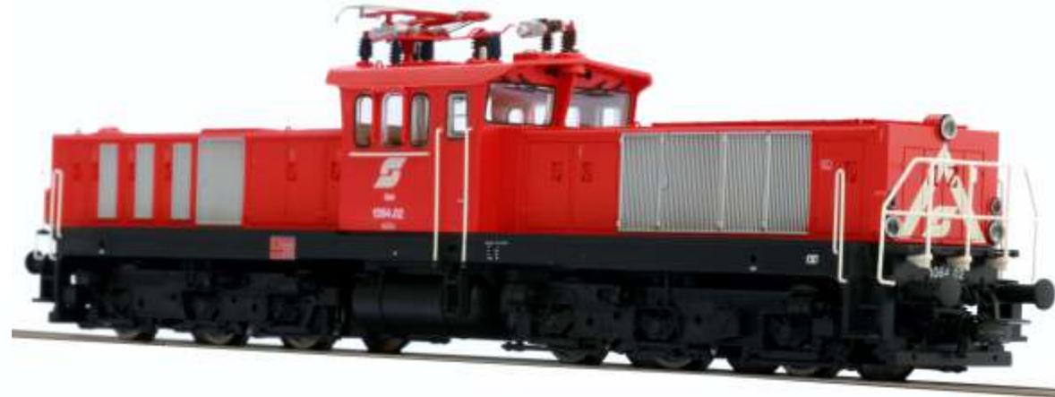
Auslieferungszustand mit "Spitz" an den Fronten, Fernlicht und Rangierlichtfunktion. 21 pin (MTC) Dekoderschnittstelle.
